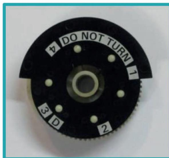
شاخص D برای تنظیم و ایجاد هماهنگی بین کلیه اجزای یک Pick module که در خارج کردن اسکناس از کاست نقش دارند بکار گرفته می‌شود.
