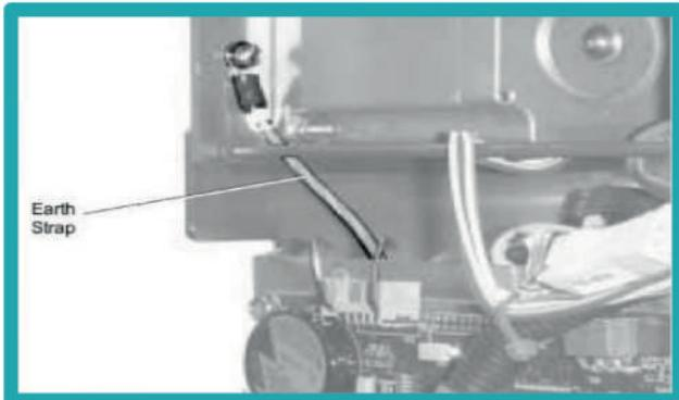
۱۱- در قسمت رو به رو سمت چپ Box یک رشته سیم ارت به بدنه دستگاه متصل، آنرا باز کنید
